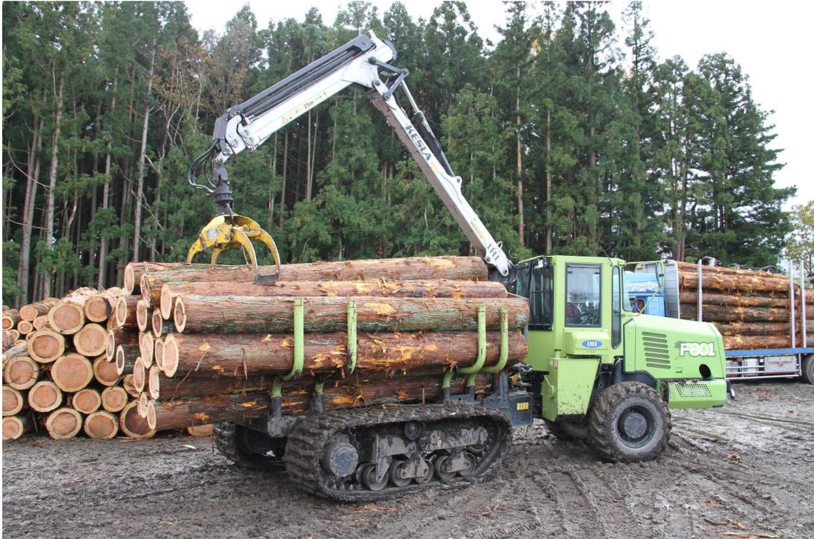
写真5・3 フォワーダで中間土場へ丸太を運搬
