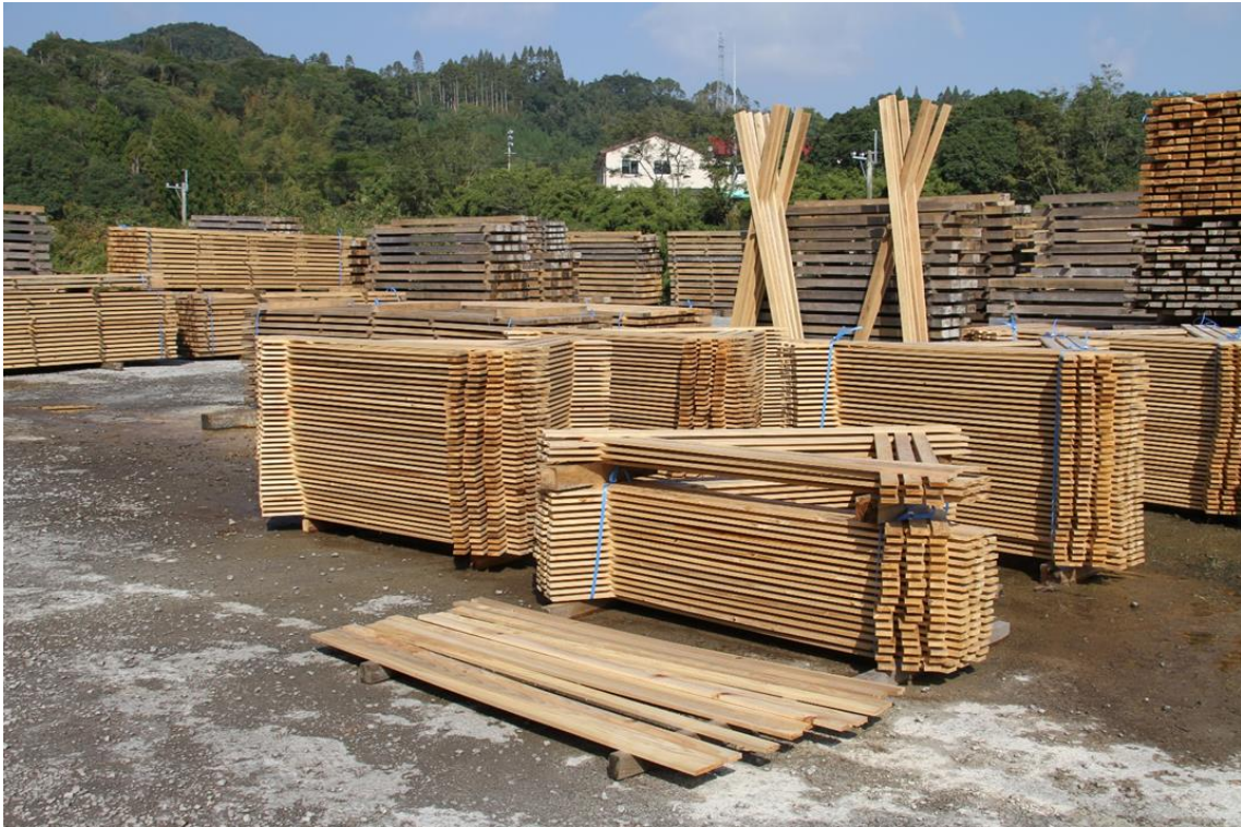
写真7 スギ板の立て掛け乾燥（後方。風通しの良い場所で天然乾燥）
