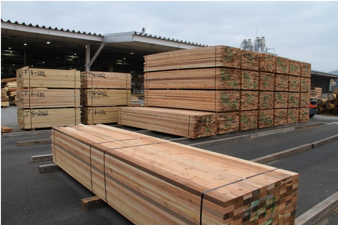
写真6 外山木材志布志第6工場のスギフェンス(4m)
