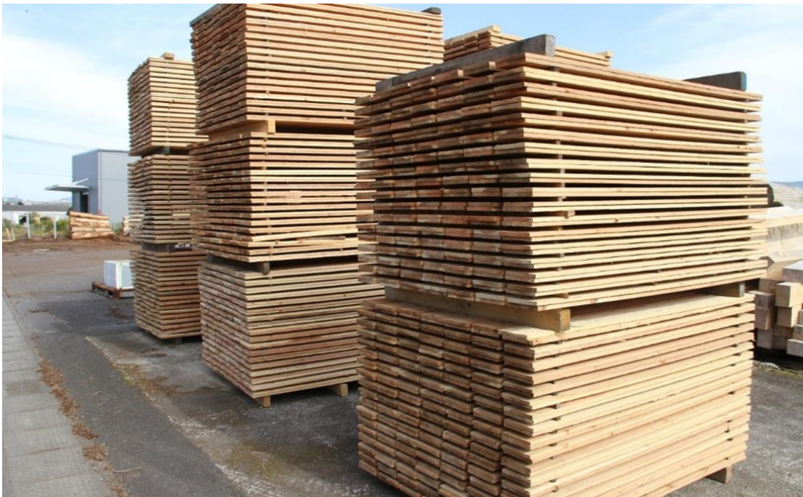
写真2 九州の製材工場で製材されたスギフェンス（天然乾燥）
