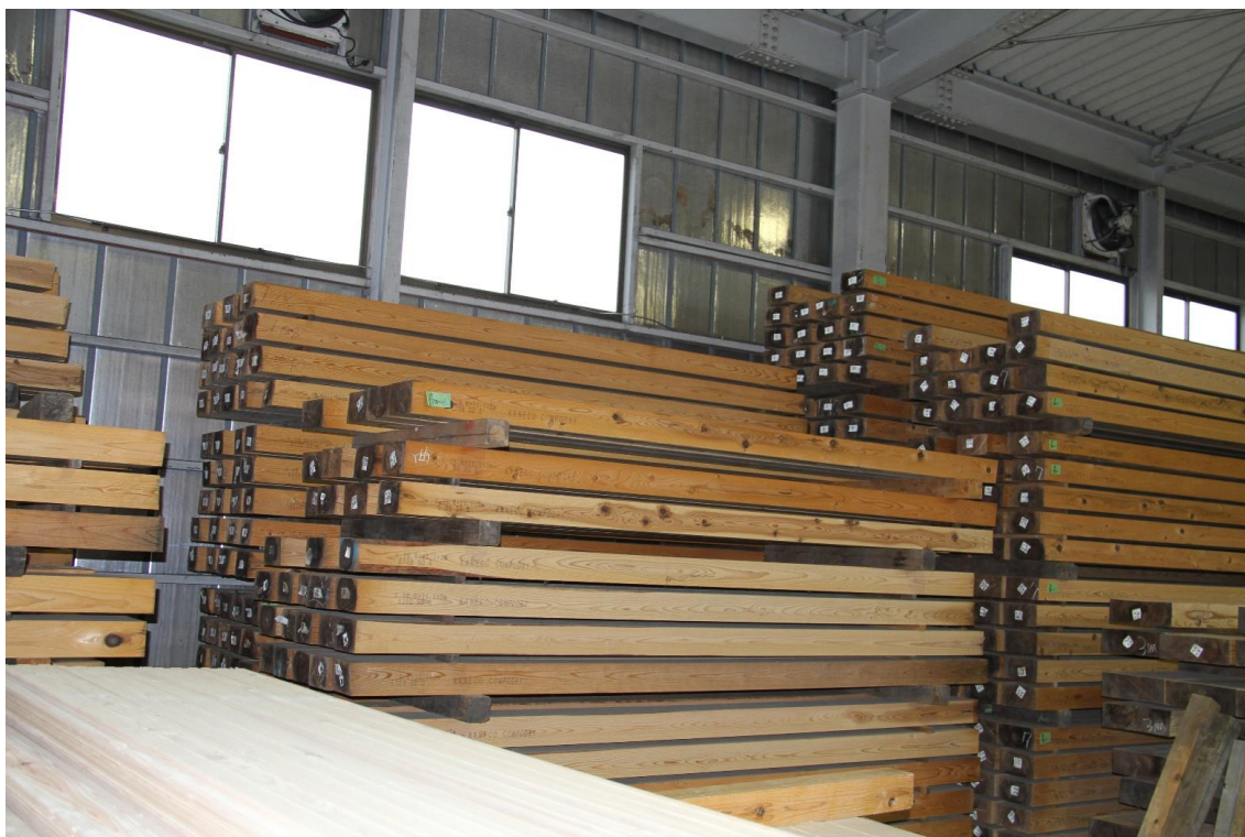
写真2 QRコードが貼られたスギ柱角（金子製材）
