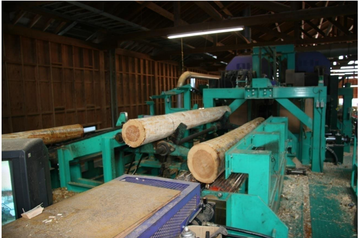
写真1 県産材加工協同組合のワンウェイのノーマンツインバンドソー
