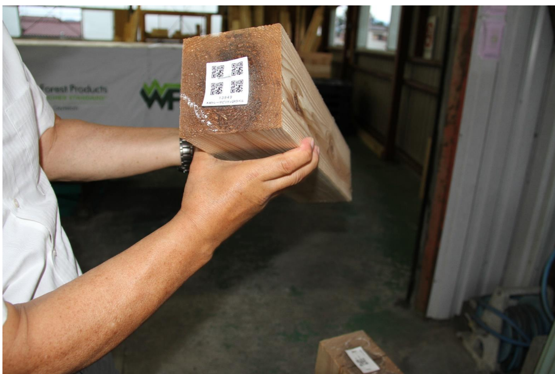
写真 3 金子製材から搬送されたスギ K D 柱角
